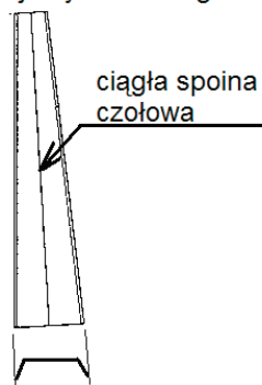
Rysunek 3. Pale specjalne wykorzystywane do zniwelowania pochylenia ścianki
